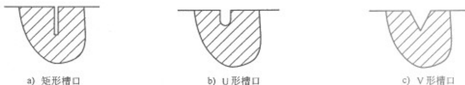
图1 槽口的断面形状
